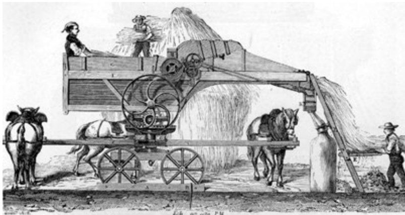
Fig. 249. — Batteuse Damsy à manège direct placé sous la batteuse.
